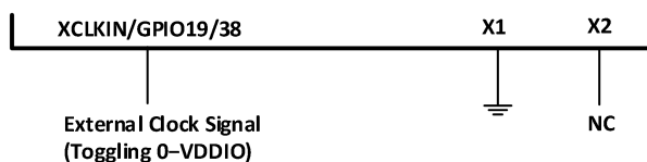
图 3-9 3.3V/5V 外部振荡器的使用
